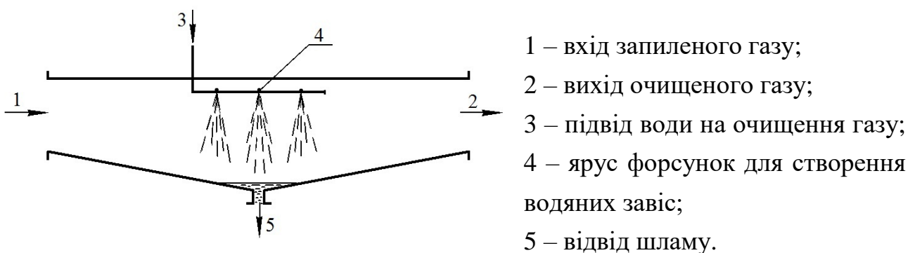
Рисунок 3.1 – Схема зрошуваного газоходу
