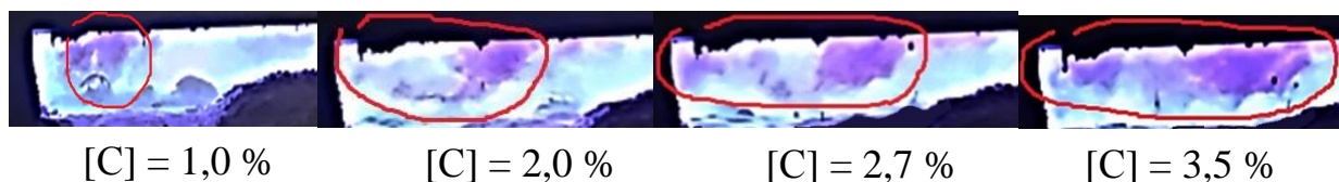
Рис. 7 Формування факела по довжині ванни, що зноситься потоком димових газів при різній концентрації вуглецю в розплаві
