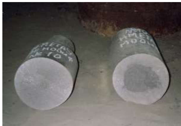
Рис. 4. Макроструктура контрольного (А) і дослідного (Б) валків
