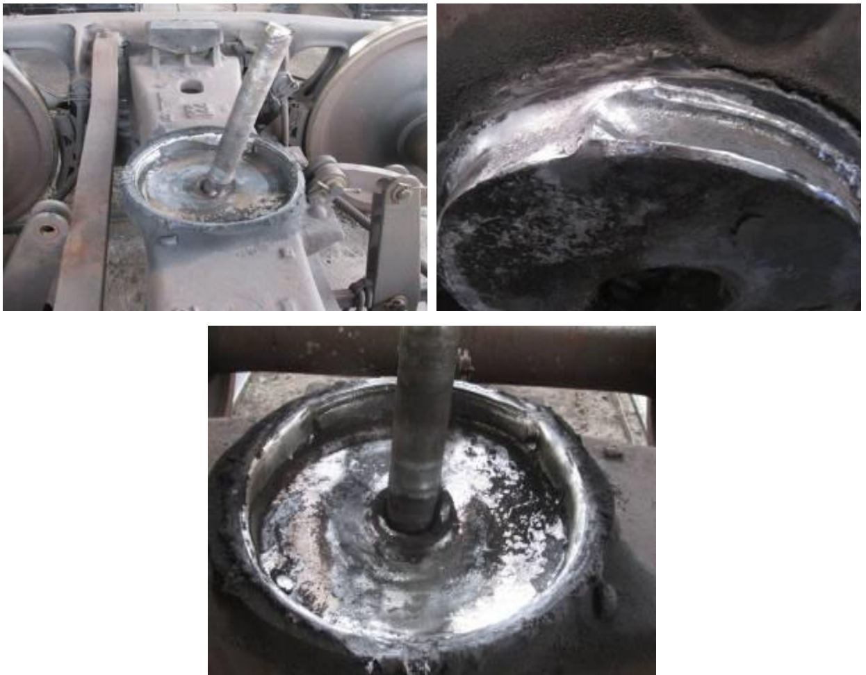
Рисунок 1.2 – Ремонтні дефекти п'ятникового вузла вагона № 68829829
