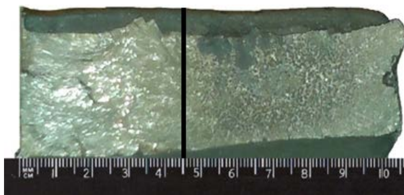
Рисунок 4.4 – Злам макроструктури технологічної проби і глибина вибілу 45 мм для валків виконання СПХН-60 з діаметром бочки 390 мм
