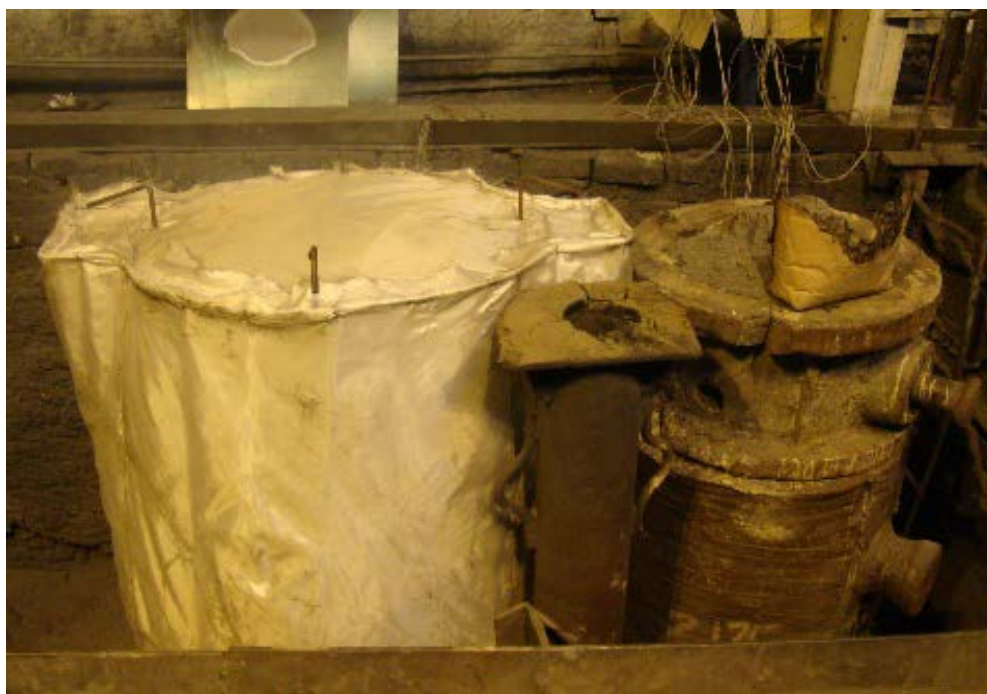
Рисунок 4.3 – Загальний вид пристрою для теплоізоляції ливарної форми, що розташований на двомісному піддоні при виконанні дослідження температури твердіння та охолодження експериментального та серійного валків
