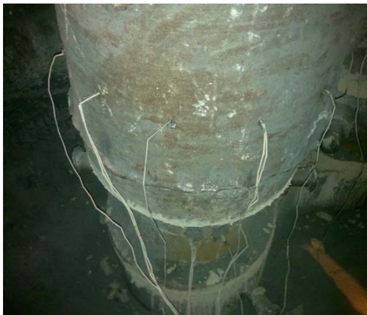
Рисунок 4.5 – Загальний вигляд ливарної форми у кесоні і термопар, які фіксували формувальними шпильками на заданій глибині у порожнині бочки
