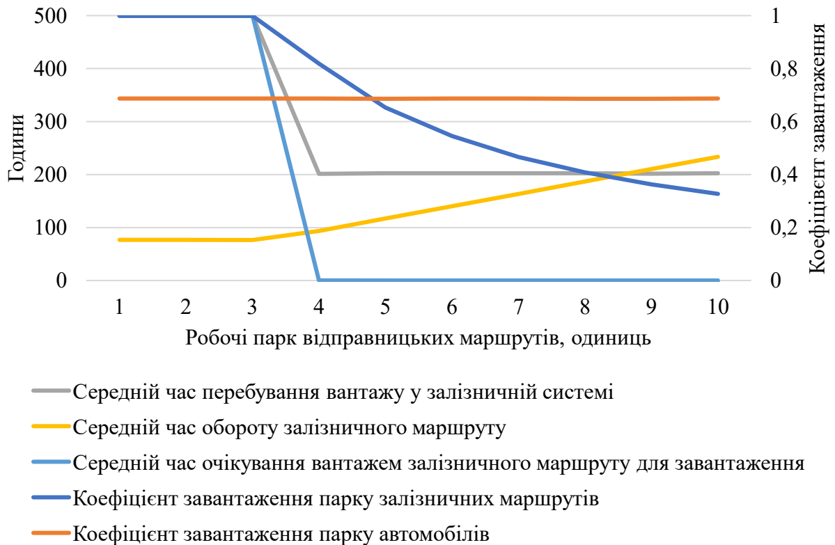
Рисунок 4.15 – Залежність основних показників функціонування залізничної транспортно-технологічної лінії від робочого парку відправницьких маршрутів при прогнозованому річному обсязі перевезення 1 млн. тонн
