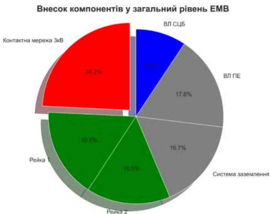
Рисунок 2.11 – Внесок компонентів у загальний рівень ЕМВ на пристрої автоматики
