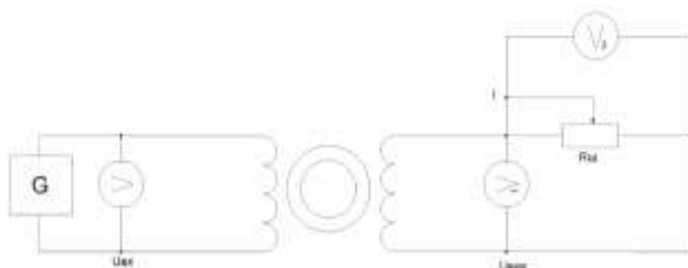
Рисунок 4.3 – Схема дослідження параметрів котушки індуктивності із нанокристалічним осердям
