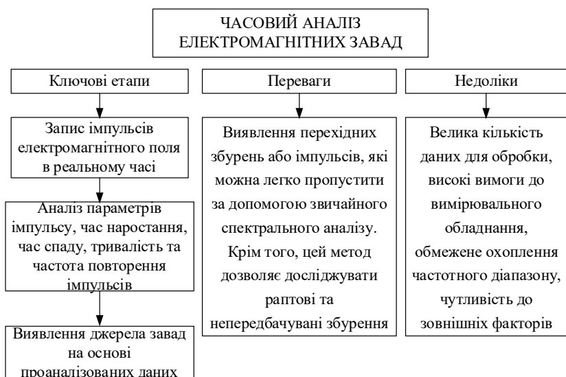
Рисунок 1.6 – Часовий аналіз електромагнітних завад
