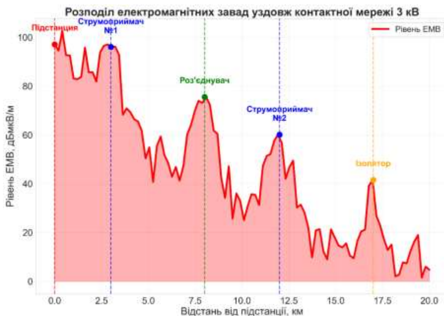
Рисунок 2.14– Розподіл електромагнітних завад уздовж контактної мережі
