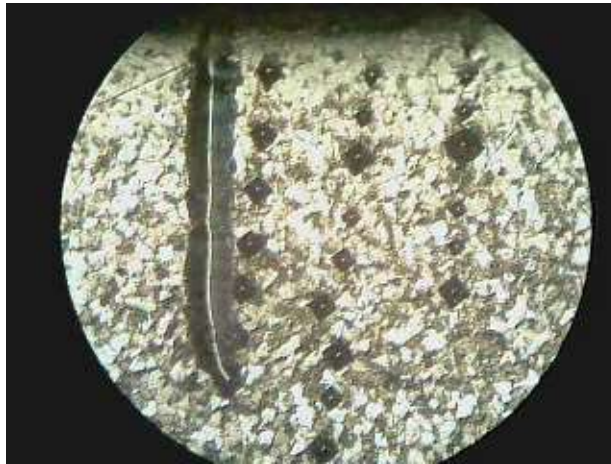
Рисунок 4.12 Мікроструктура матеріалу поверхневого шару кільця трубі після витримки 40 годин при нагріві у печі 900 °С.
