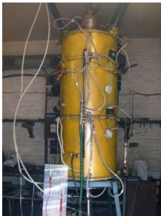
Рисунок 3.2 Пілотна піч продуктивністю 10 кг/год
