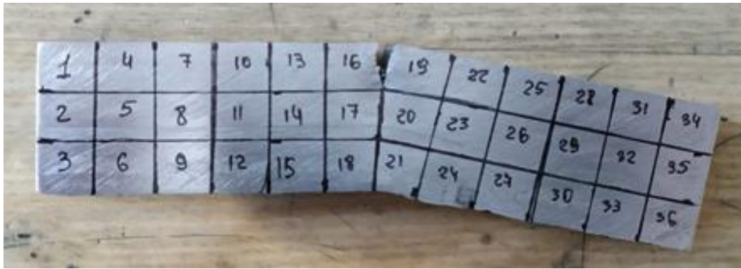
Рисунок 3.20. Підготовка зразків для вимірювань твердості.
