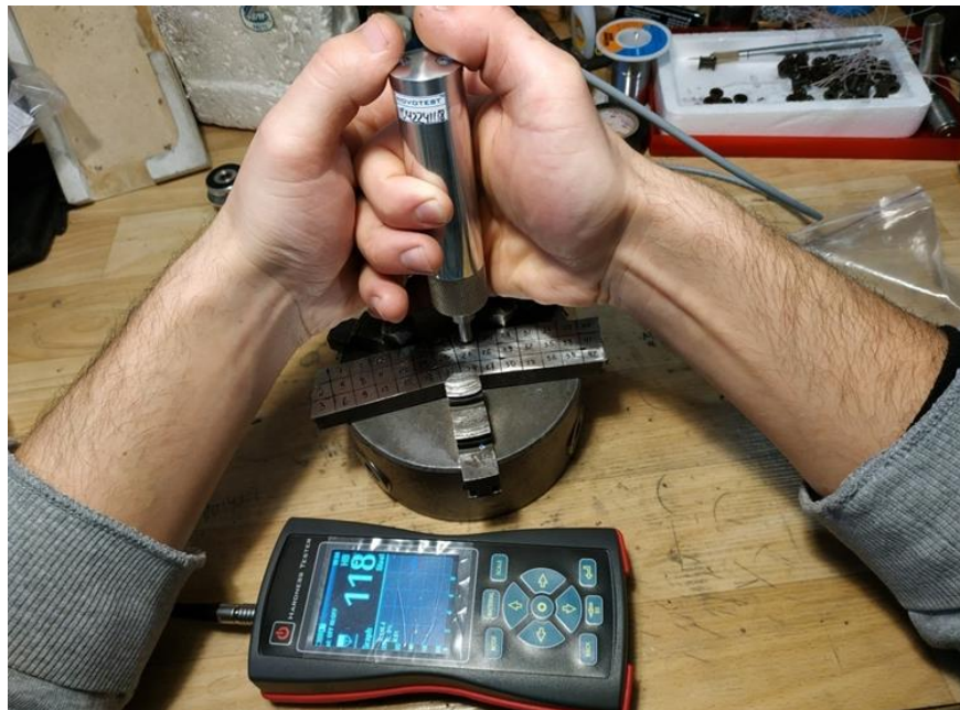
Рисунок 3.21. Вимірювання твердості зразків.
