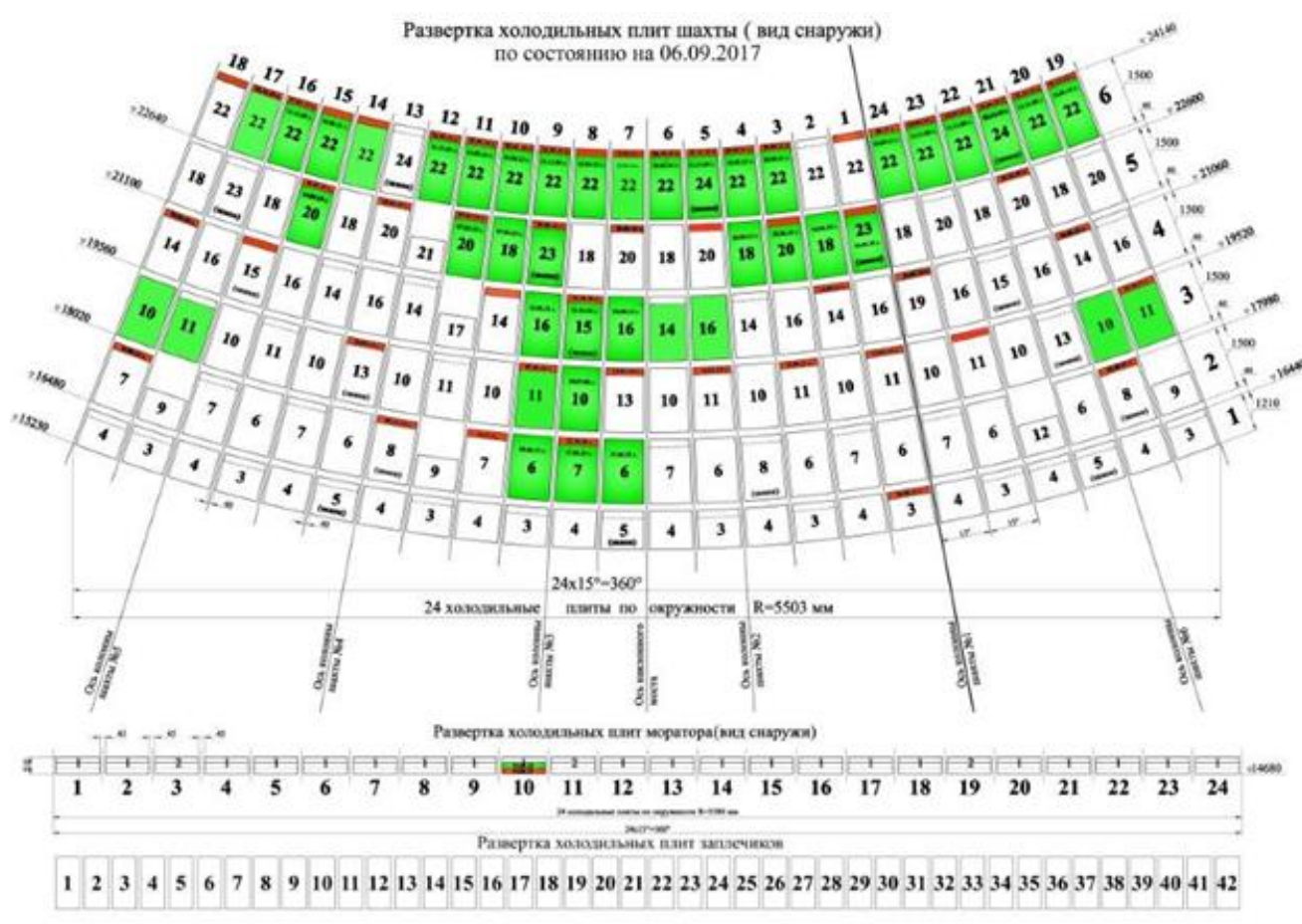
Рисунок 3.1 – Схема розгортки холодильників ДП (зеленим показано непрацюючі).
