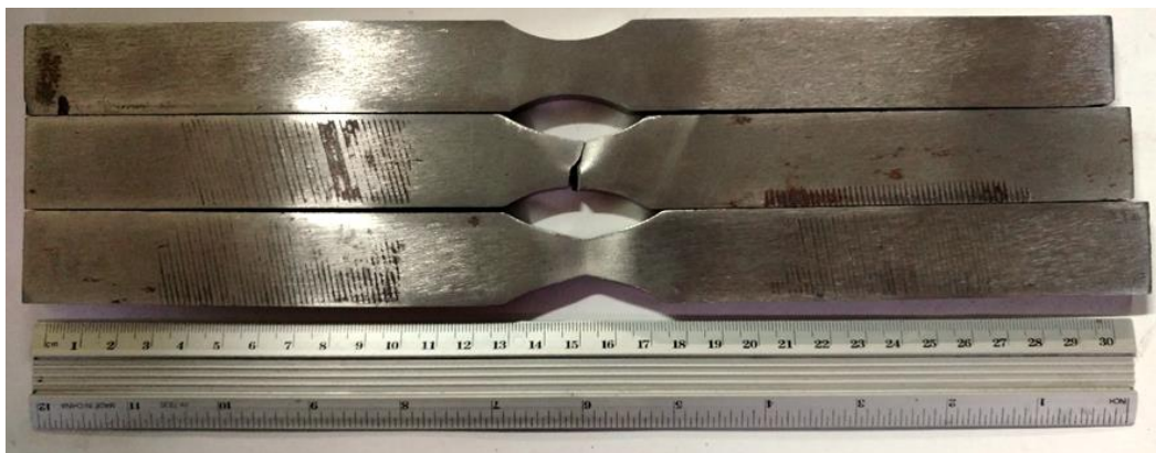
Рисунок 3.25. Зразки сталі 09Г2С, що вирізані з візків локомотива після його 30-річної експлуатації: зразок до випробувань (угорі), після втомних випробувань на розтягування в багатоцикловій області (у середині), після повторно-статичних випробувань в квазістатичній області (знизу)
