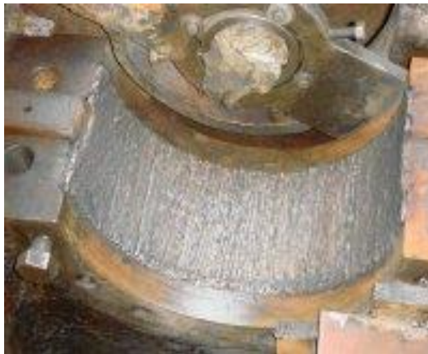
Рисунок 1.2 – Наплавлена опорна поверхня.
