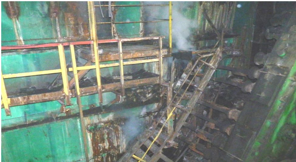
Рисунок 2.3 – Результат корозійного зносу броні струмків МБЛЗ
