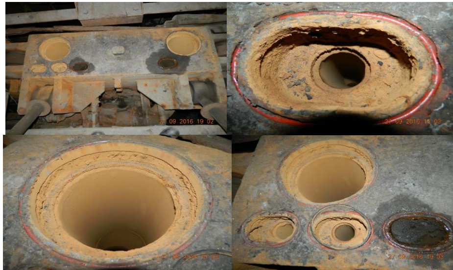
Рисунок 2.6 - Зношена канавка під ущільнення
