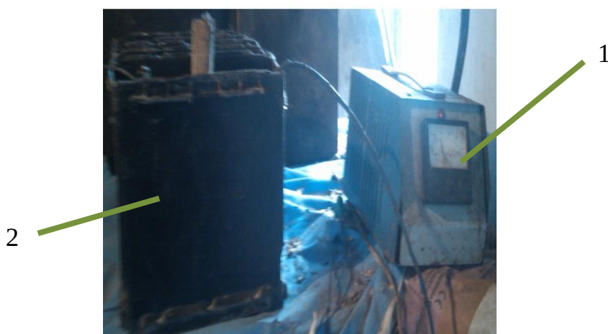
1- джерело постійного струму; 2- хімічностійка ємність
