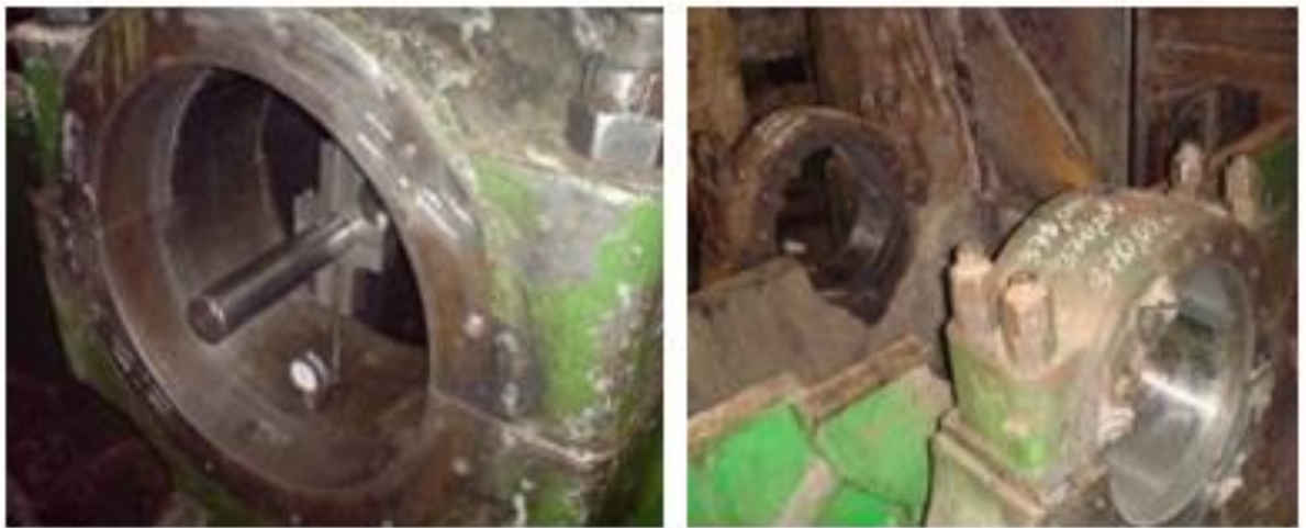
Рисунок 5.2 - Знос опорних поверхонь під підшипником
