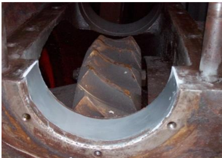
Рисунок 5.3 - Підшипникова опора, котра відновлена за допомогою композитного матеріалу
