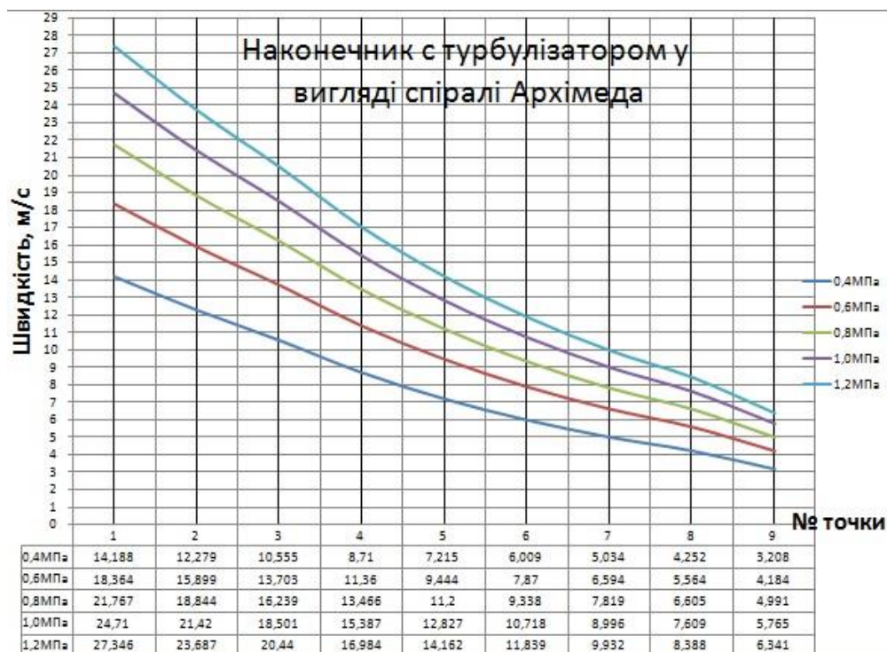
Рис. 3.14. Зміна швидкостей потоків охолоджувальної води в точках сканування біля поверхні вінця в наконечнику з турбулізаторами у вигляді спіралі Архімеда
