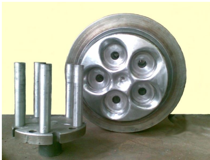
Рис. 4.7. Виготовлена матриця штампа для заготовки мідного вінця з виштовхувачем
