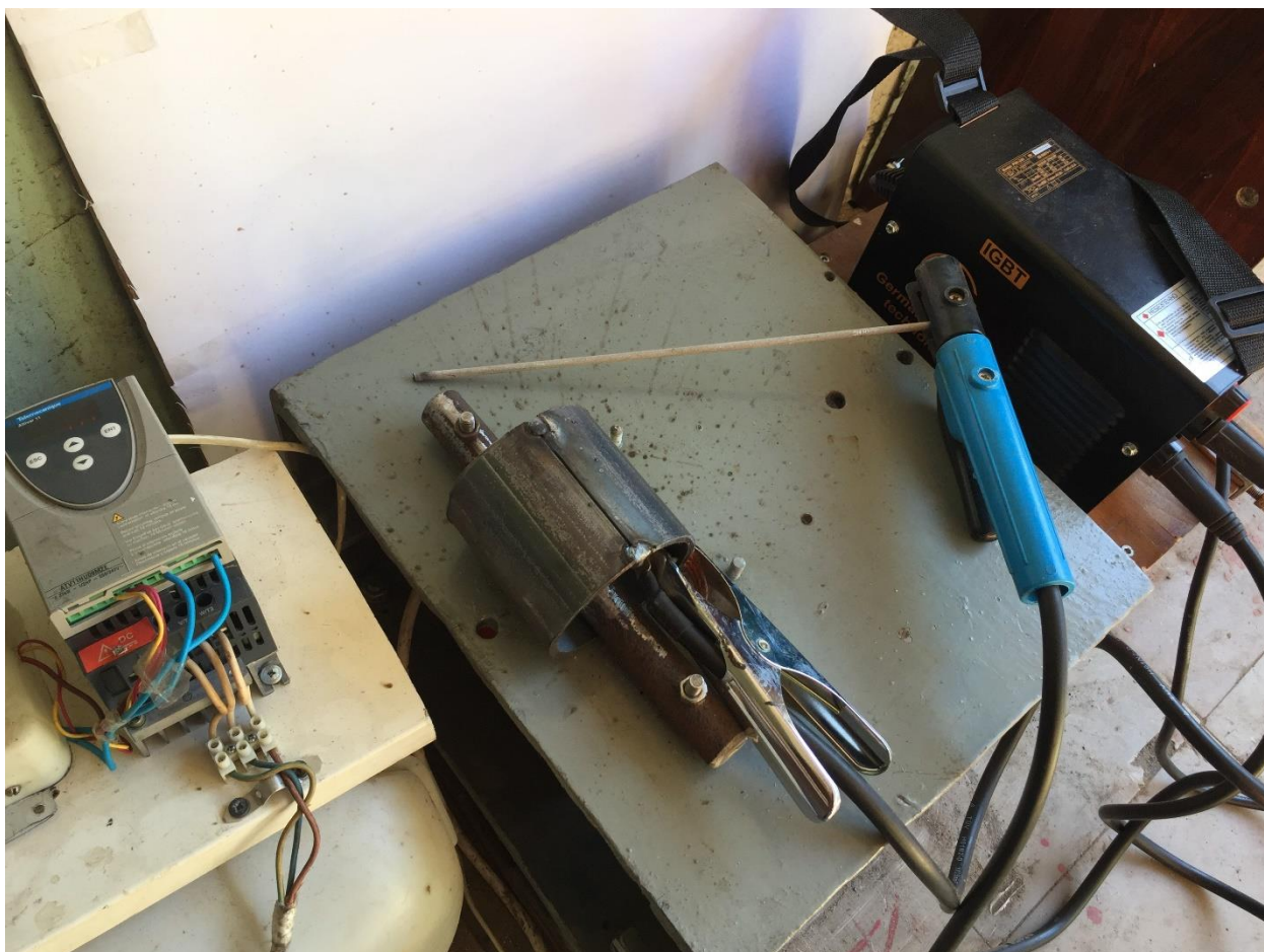
Рис. 3.9. Трубна заготовка на робочій поверхні вібростолу в процесі зварювання.
