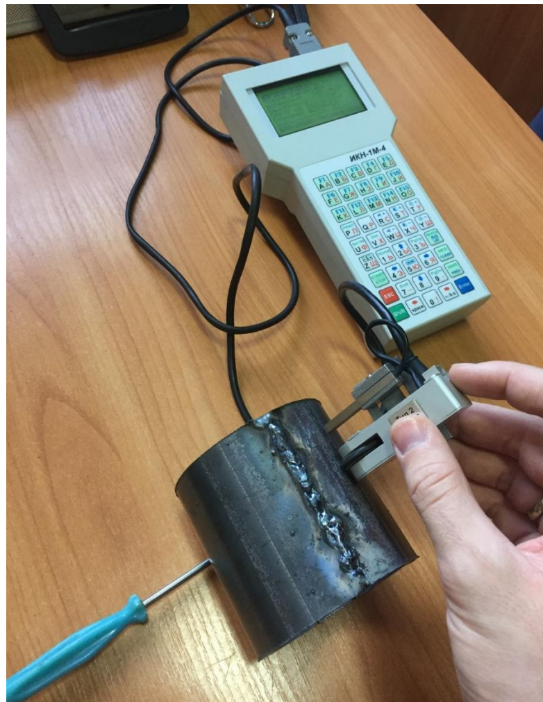
Рис. 3.10. Процес вимірювання залишкових напружень в зразках методом магнітної пам'яті металу
