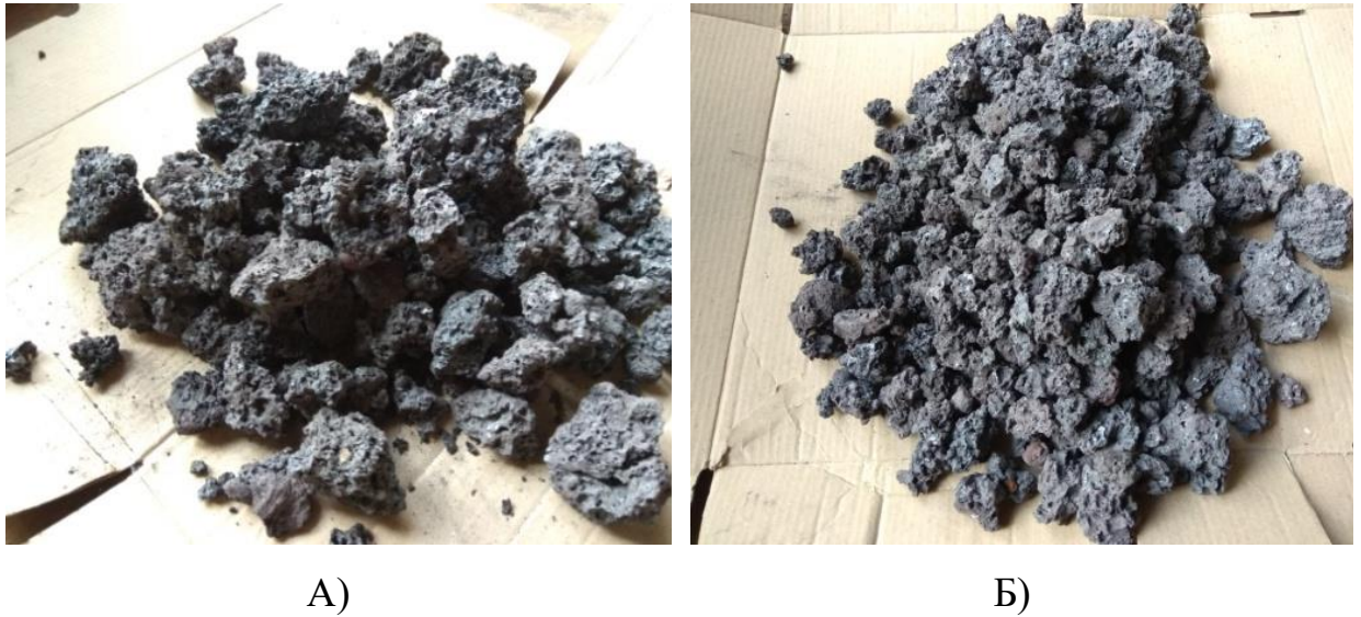
Рис. 4.1 – Вид агломерату до (А) та після (Б) механічної обробки в дослідному барабані
