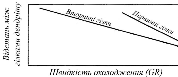
Рис. 1.20. Характер залежності відстані між гілками дендриту від швидкості охолодження
