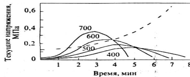
Рис.17.1. Зміна в часі поточних напруг, що викликаються надлишковим тиском в окатишу при різних температурах сушки.
