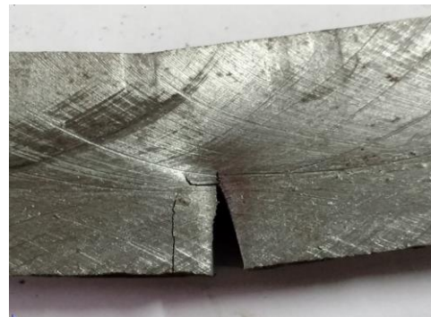
Рисунок 3 - Зміна траєкторії тріщини при досягненні критичного КІН
