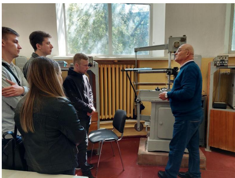
Розривна машина для випробувань зразків металів на розтяг Р-5 (максимальне навантаження 5000 кгс)
