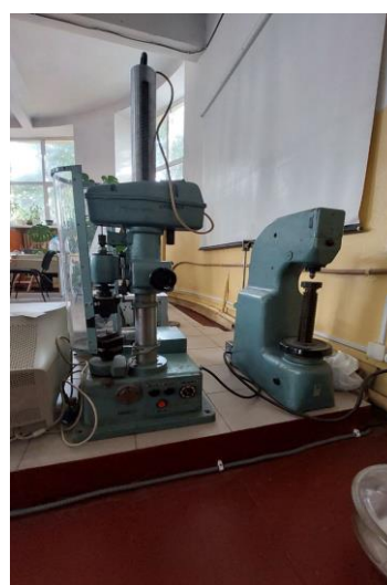
Машина для випробування дроту на кручення та твердомір ТШ-2
