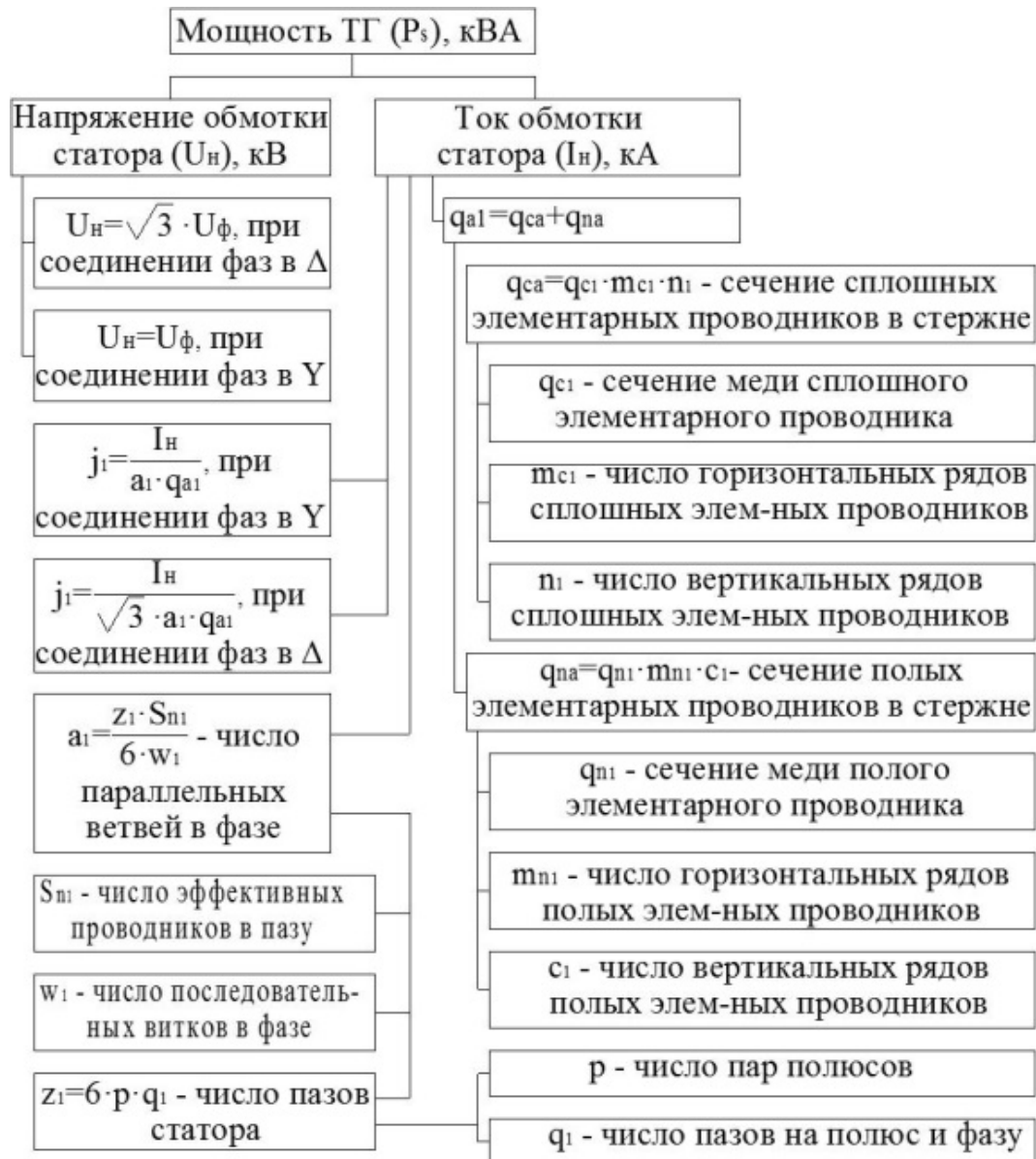
Рисунок 1 – Простейшая модель полипараметризации трехфазного синхронного турбогенератора
