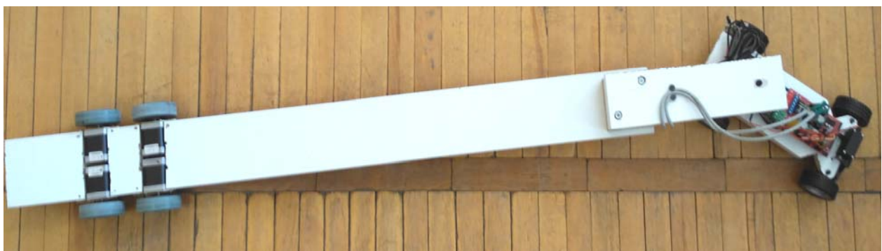
Рисунок 1 – Модель автопоїзда з керованою причіпною ланкою
