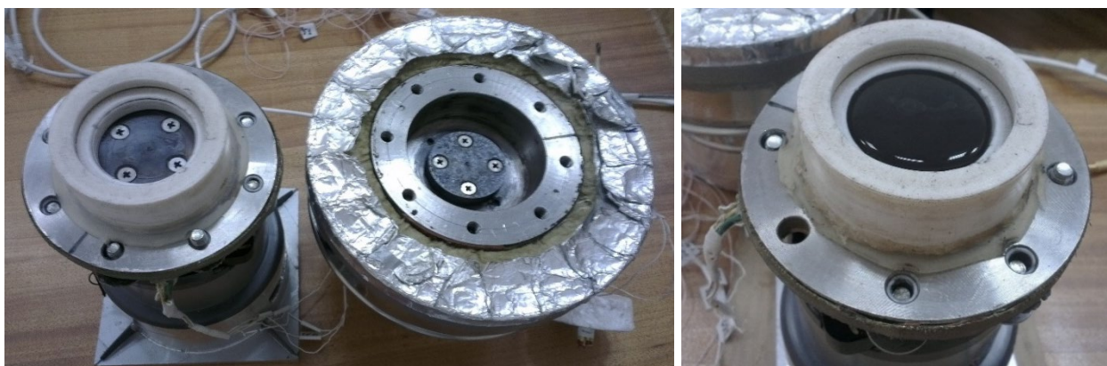
Рисунок 3.2 - Експериментальна установка для визначення коефіцієнта теплопровідності водовугільного палива
