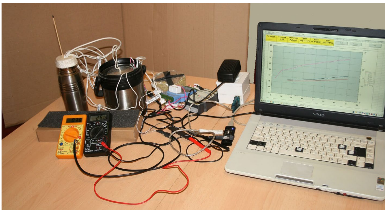
Рисунок 3.7 - Експериментальна установка для визначення теплоємності водовугільного палива
