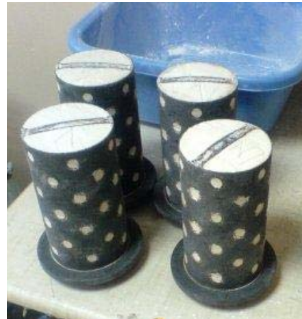
Рис. 2 - Подготовленные опоки к прокатке
