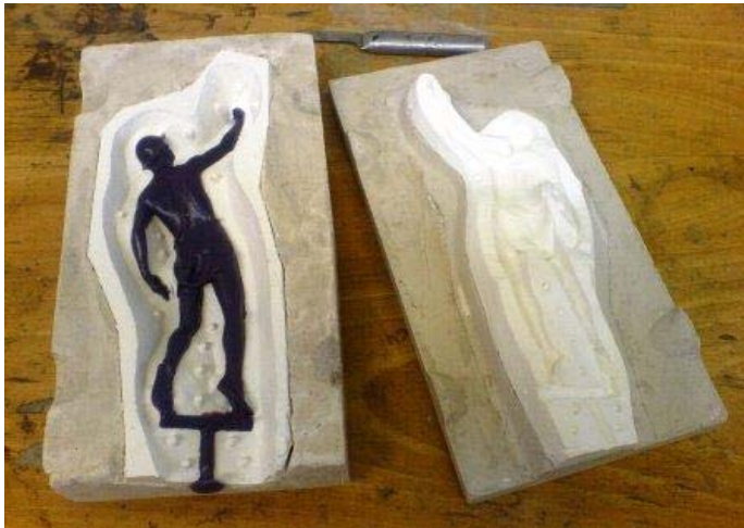
Рис. 1 – Разъемные полуформы с моделью бога торговли Меркурий
