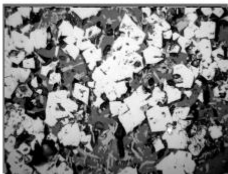
Рисунок 5. Мікроструктура офлюсованого агломерату при заміні 30% концентрату залізною рудою. Магнетит – біле, скло фаза – сіра, голчаті кристали ферита – світло-сірі. Відбите світло, x500
