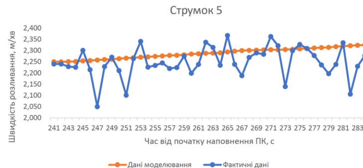
Рис.7 Порівняння фактичної швидкості розливання струмка №5 з даними моделювання
